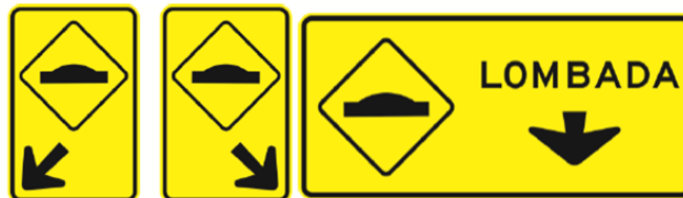
Figura 54. Sinalização de advertência aplicada em lombadas.
