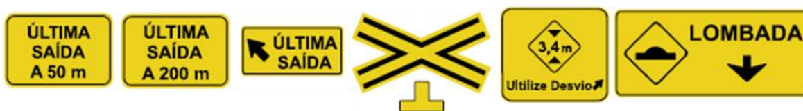
Figura 30. Exemplos de informações complementares em placas de advertência.
