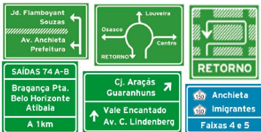
Figura 37. Placas de orientação de destino.
